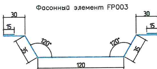
Рис.3. Узел примыкания к стальному несущему элементу
