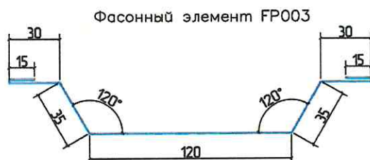
Рис.2. Узел примыкания к ж/б несущему элементу
